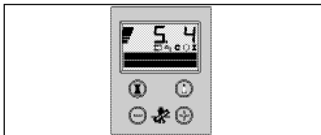
Рис. 7.20 Индикация на дисплее/режим отопления
