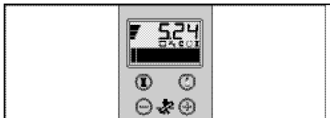
Рис. 5.8 Индикация на дисплее/загрузка водонагревателя (только для VC)
